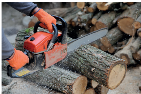
Abb. 7.3: Handgeführte Motorkettensäge: Übertragung der Vibration auf die „angekoppelten“ Hände (AdobeStock©byrdyak)
